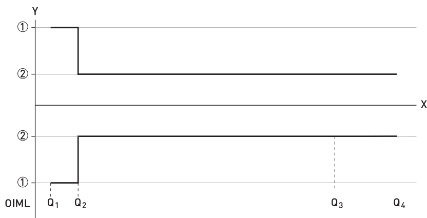
Рисунок 2-1: Расходы согласно стандарту Международной организации по стандартизации (ISO) добавлены к рисунку для сравнения с директивой по измерительному оборудованию (MID)
